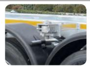
Opção: Twistlock adicional, rebatível, que permite a carga de um contentor de 20' avançado, aumentando a distribução de pesos no eixo motriz do trator.
