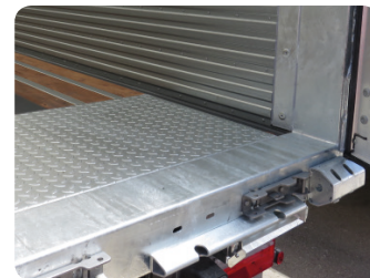
Chapa acceso carretillas
