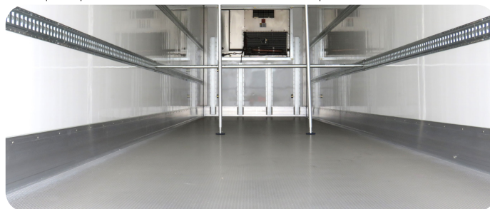
Suelo de aluminio, zócalo de aluminio y guías de amarre de carga
