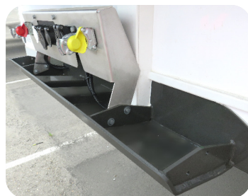
Supporto connessioni Inox e invito ralla XLarge rinforzato
