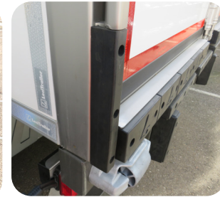
Tamponi laterali verticali e tamponi coperti con lastra acciaio inox
