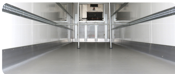
Pianale in alluminio, zoccolo battipallet in alluminio e cremagliera fermacarico
