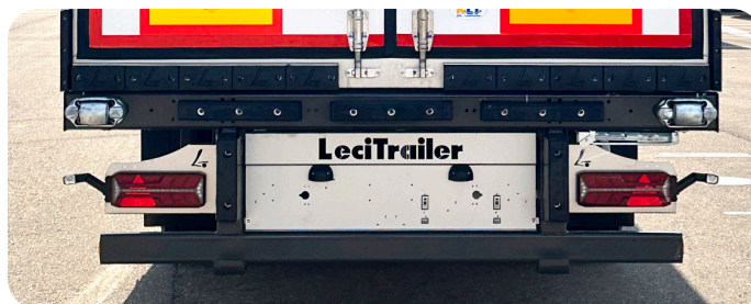
Sezione posteriore rinforzata
