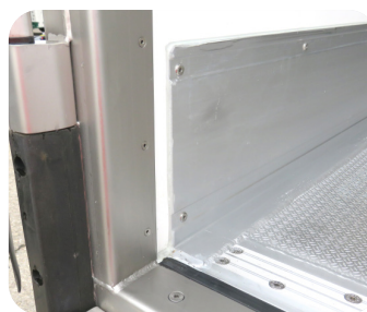
Rottura ponte termico in gomma e profilo in alluminio pianale
