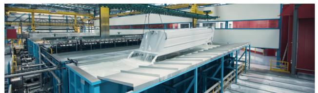
KTL: Proteção contra corrosão em chassi e caixa por cataforese
