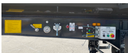
Suspensión de tres posiciones y ayuda a la tracción
