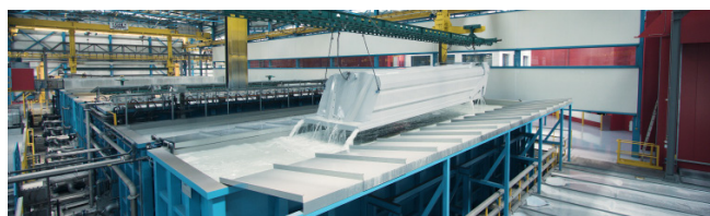
KTL: Protección anti corrosión en chasis y caja por cataforesis
